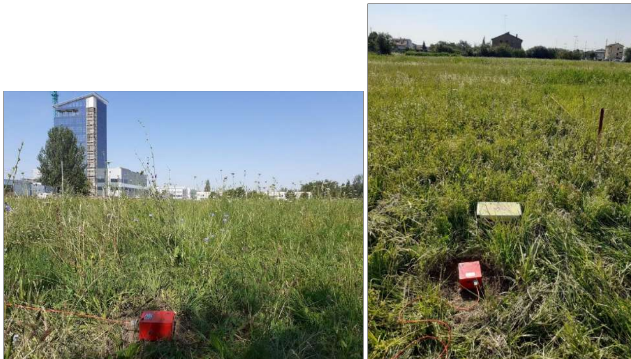
Figura 8: immagini della prova geofisica HVSr 1 e HVSr 2
