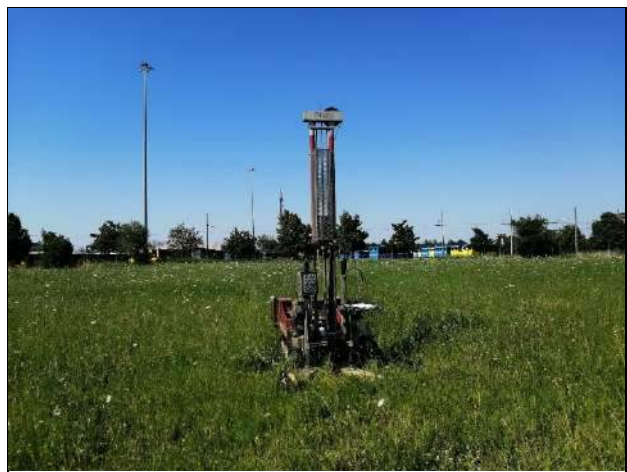
Figura 6c-d: immagini della prova penetrometrica CPT3 e CPT4
